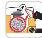
Sistema CCS (Sistema de combustión combinada), limpia el aire de la combustión antes de llegar al filtro de aire. Aumenta la potencia, reduce el consumo y mantiene mas tiempo limpio el filtro de aire.
